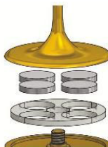
Figura 6 Esquemático das peças disposta para formação do Pião Simétrico
