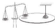
Figura 2 - Desenho esquemático do aparato experimental para os dados experimentais das forças de sustentação e de arrasto
